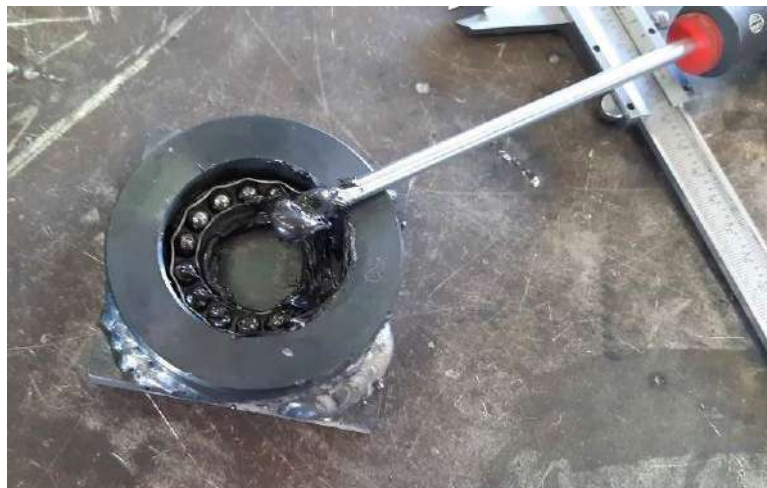
Photo V1.5 : bague d'arrêt remplacée par A11 et butée à bille remplacée par roulement conique
