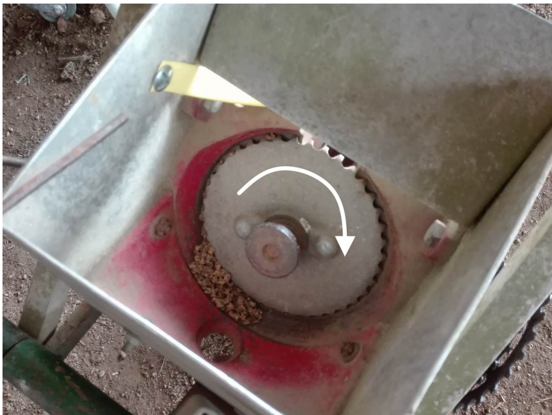
Le distributeur est à disque cranté, et entraîné par la roue et une chaîne.
