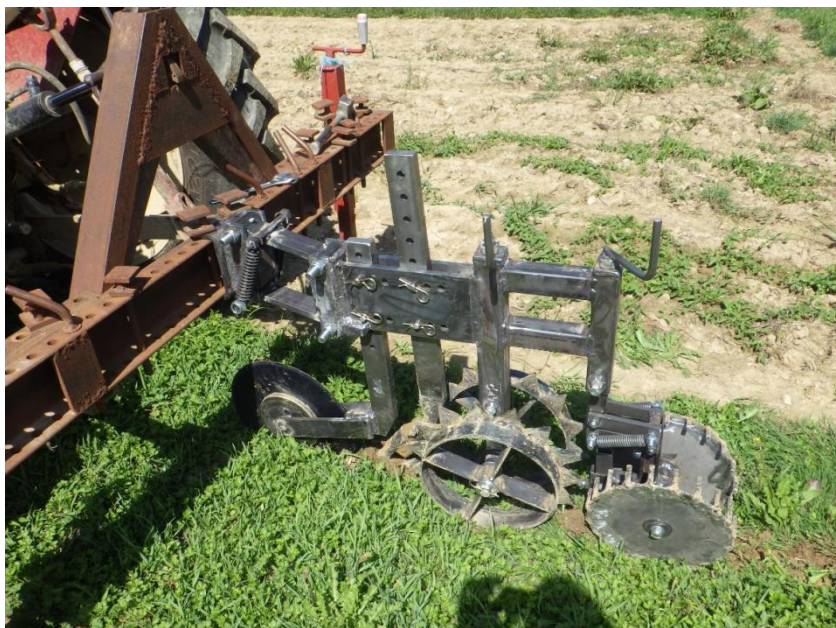
Figure 7: Prototype de Strip-till l'Atelier Paysan, attelé à un tracteur
