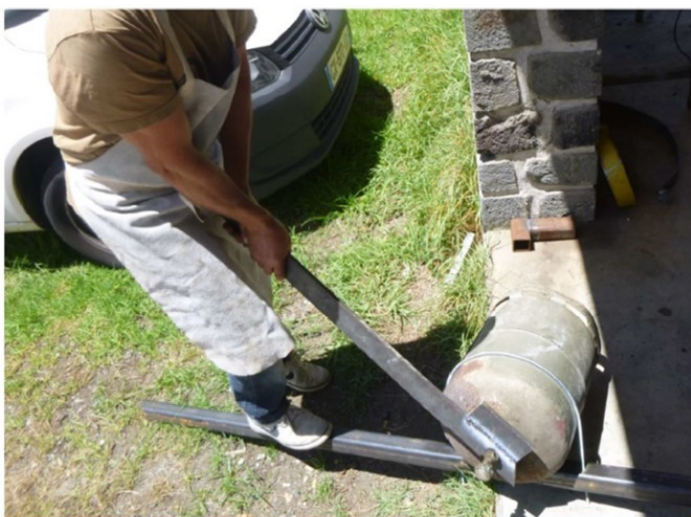
Démontage des robinets des bouteilles de gaz avant dégazage à l'eau
