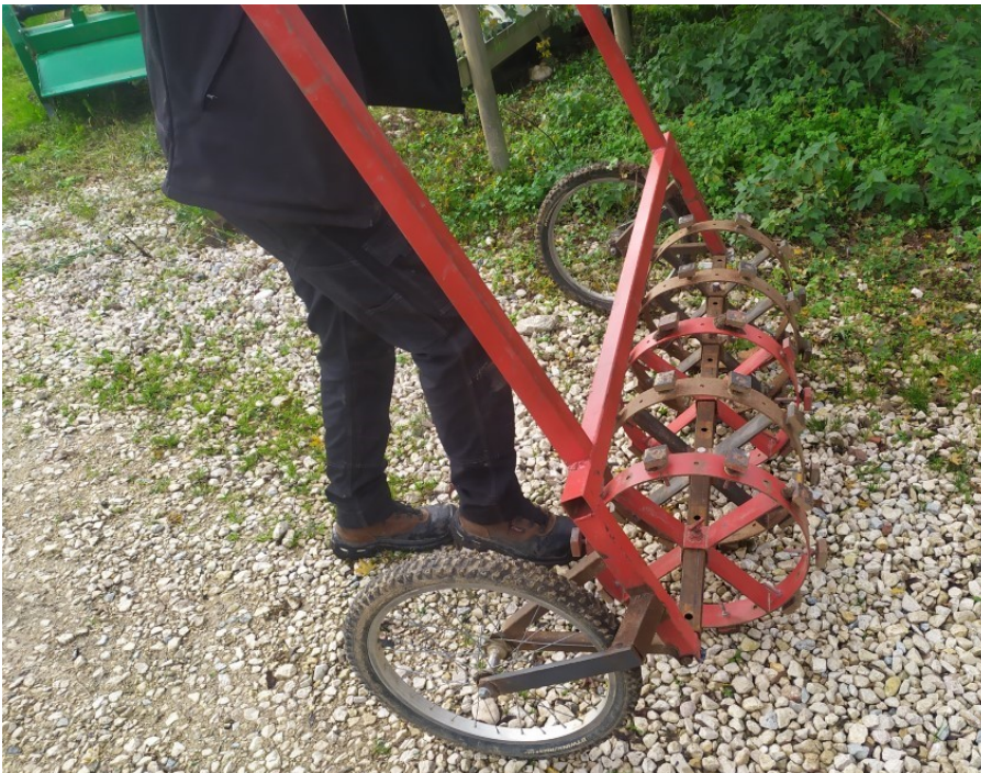
Figure 9: Personne en position pour installer le rouleau équipé de 5 roues marqueuses
