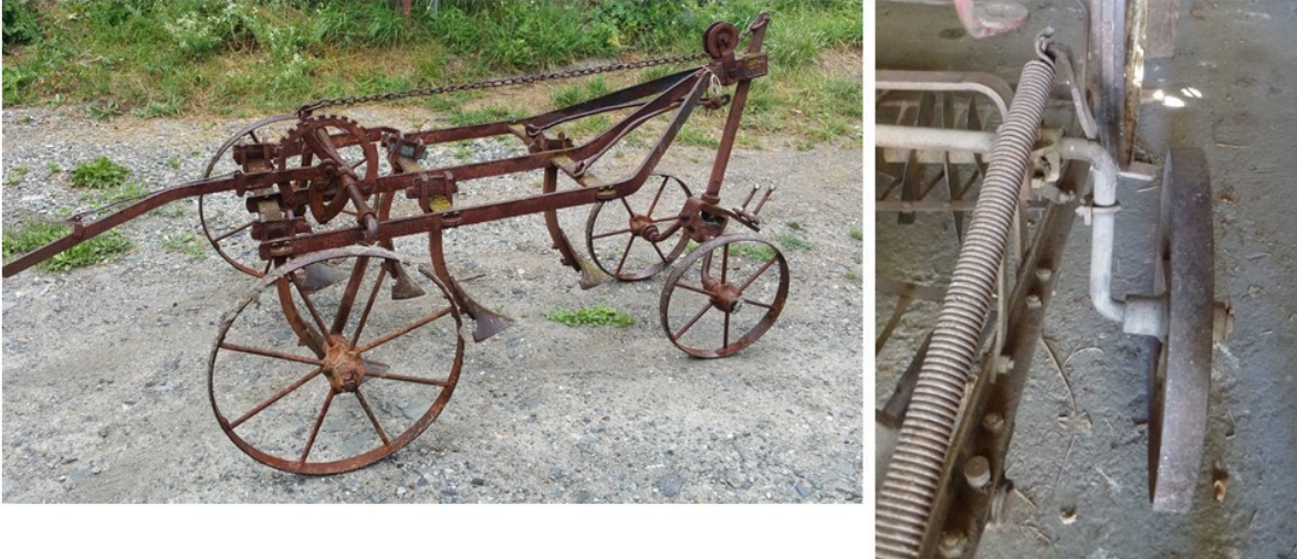
Figure 20: Principe du relevage par essieu coudé pivotant sur son axe :
