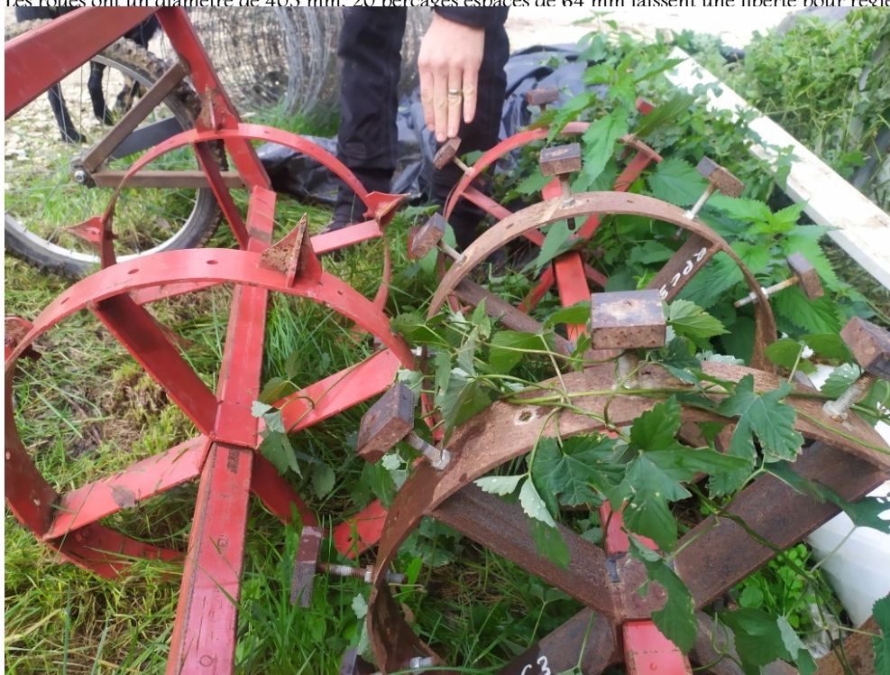
Figure 11: Roue perceuse montée sur l'outil, roue marqueuse à monter
