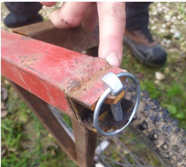
Figure 10: Aperçu du logement de l'axe et des goupilles clips.
