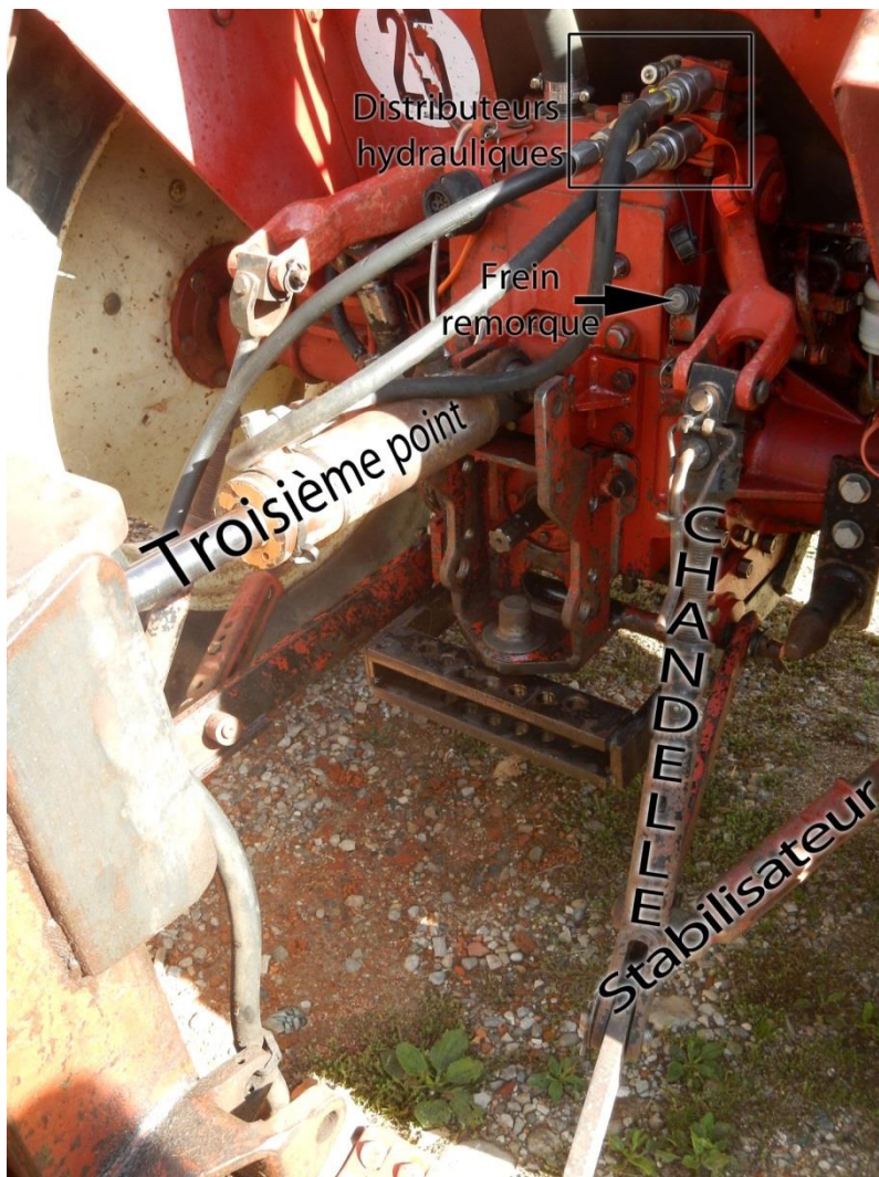
Figure 11: Arrière du tracteur, fixation de l'outil
