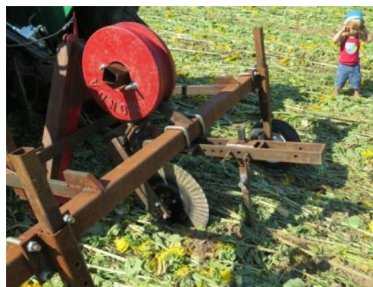
Ci-dessus : Le disque est incliné vers l'arrière et reste bien dans l'axe de la dent
