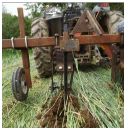
Ci-dessus : Le disque est décalé par rapport à la dent car il est incliné vers l'avant.
