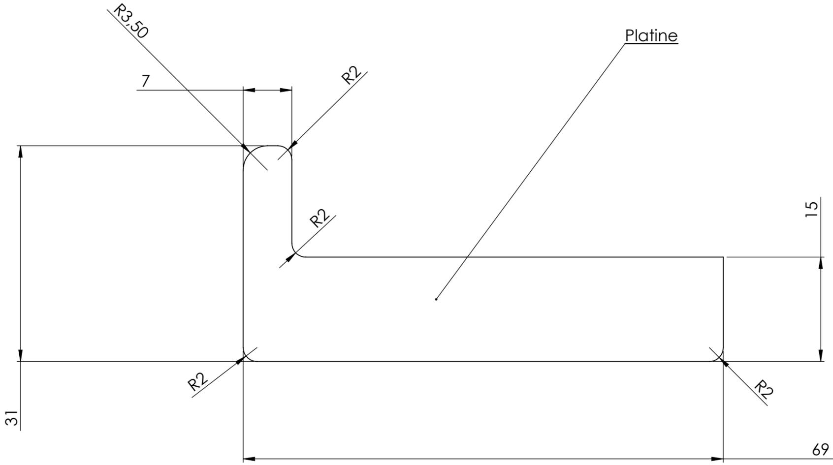
Platine pouvant être réalisée à partir d'un fer plat
